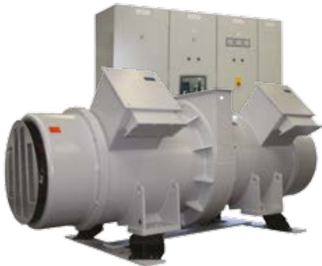
12-1500kVA 50/60Hz or 60/50Hz MG-Set.
