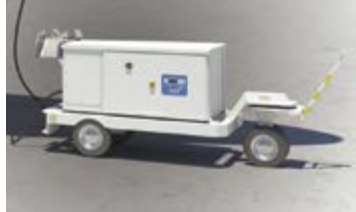
90 kVA Mobile Solid State 400 Hz GPU.
